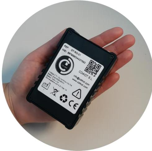
El DISPOSITIVO dispone de sensor de temperatura y localización. Lleva embebida una SIM europea que le permite disponer de la conectividad necesaria para enviar los datos de los sensores de temperatura y localización a la nube.
