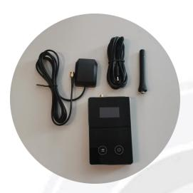
El DISPOSITIVO MDD-0022 es un dispositivo con pantalla LED, compacto y pequeño de 110 \* 70 \* 21 mm y 235 gr de peso que dispone de GPS, sensor de temperatura y humedad interno y un conector para sonda externa adicional.
