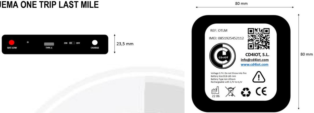
El material de la cubierta es plástico 475 (poliestireno de alto impacto o HIPS). El mayor uso específico de HIPS es como material de embalaje y desechable, especialmente materiales de embalaje de alimentos y vajilla para comer. Por lo tanto, la carcasa puede estar en contacto con productos destinados al consumo humano.
